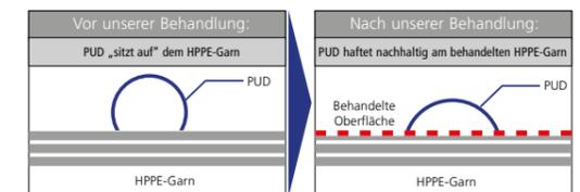
HPPE-Garne aus PE haben eine lange Moleküllänge. Die PUD-Beschichtung kann sich wegen geringer Haftung leicht lösen. Durch unsere neueste Produktionsmethode wird die Haftung der Oberflächenbeschichtung deutlich verbessert.
